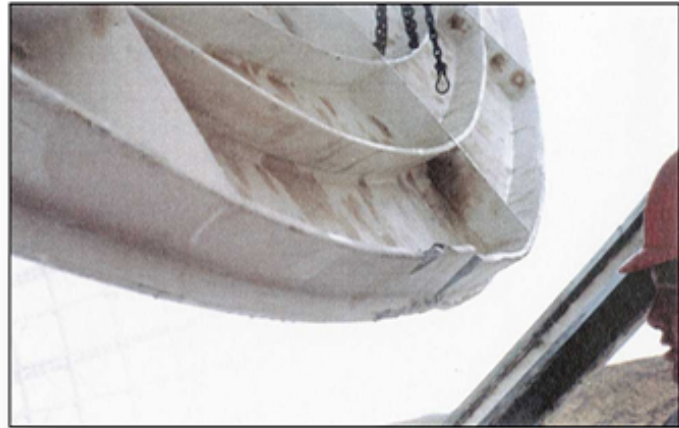
Subreflector Lower Edge Damage
